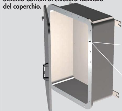
La chiusura del coperchio di una custodia montata su telaio verticale viene facilitata da una guida avvitata sul corpo. Questo sistema viene utilizzato nelle custodie EJBX-4 /4B, EJBX-45 /45B, EJBX-5 /5B, EJBX-6 /6B, EJBX-7.
