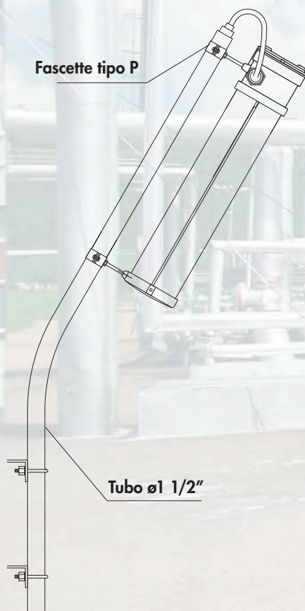
Montaggio a palo per FLF...L con pressacavo
