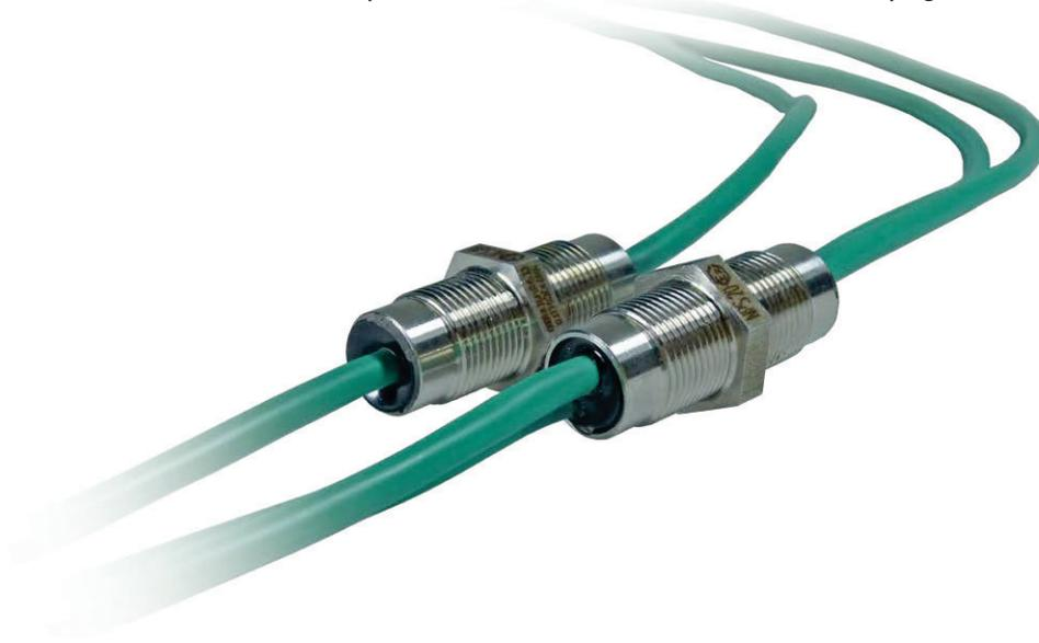
I passanti sigillati vengono utilizzati per unire tra loro custodie antideflagranti. I cavi vengono sigillati mediante una resina bicomponente che viene applicata su ogni conduttore.
